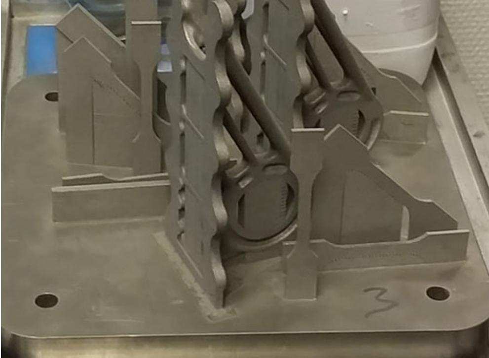
Kuva 3. Esimerkki vetokoesauvoista, joita tulostetaan jokaisen tulostuskerran mukana (Lähde: Airbus)
