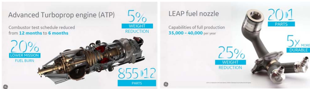
Kuva 21: Esimerkkejä lisäävän valmistuksen käytön hyödyistä GE:n tuotannossa. Lähde: Mohammad Ehteshami, GE, “Accelerating the additive revolution”, Formnext 2016
