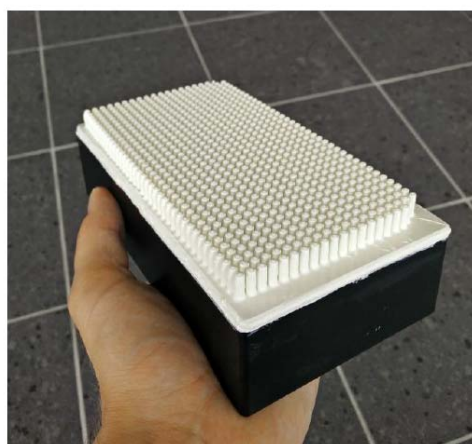
Kuva 11: Keraamisten komponenttien sarjavalmistusta, Lähde: Admatec, Formnext 2016
